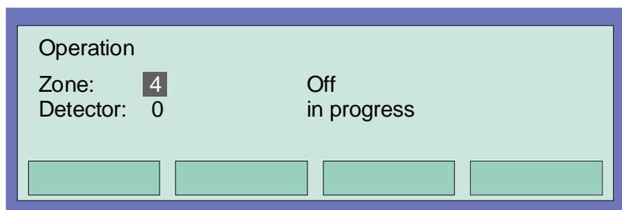
Fig. 19: Visualizzazione del disinserimento della zona 4
