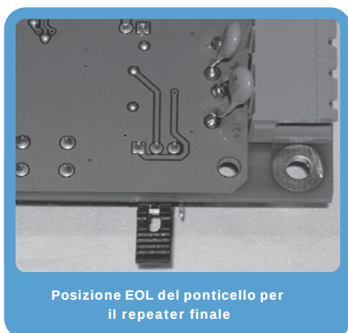
Figura 26 - Scheda SmartLetUSsee/LCD-Lite - posizione del ponticello
