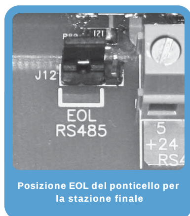
Figura 27 - Scheda SmartLevel - posizione del ponticello
