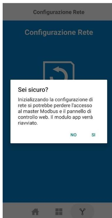
L'OPERATORE può scegliere se proseguire premendo "Si" oppure annullare premendo "No".
