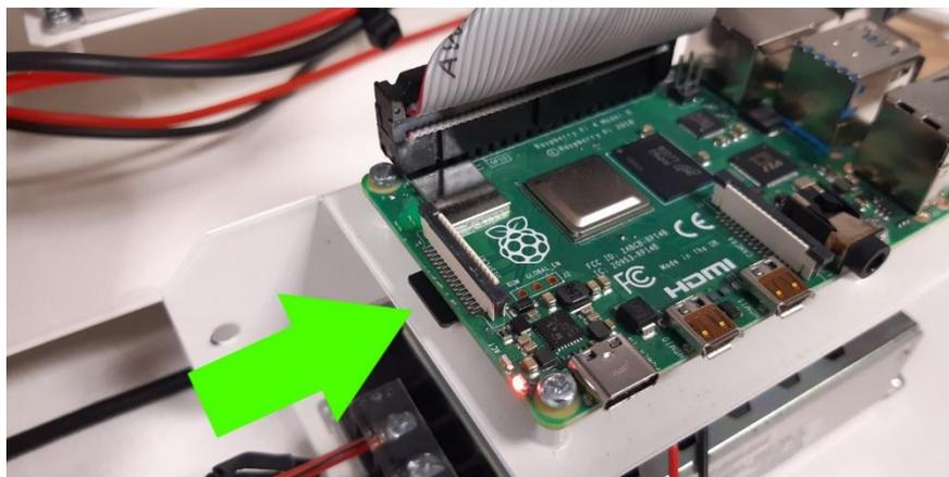
Figura 5 - Posizionamento microSD nell'apposito slot della scheda Raspberry (contatti rivolti in alto)
