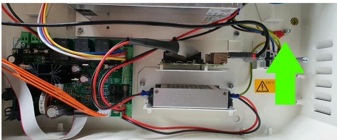
Figura 7 - Morsetto di collegamento cavo messa a terra per Master Black Compact
