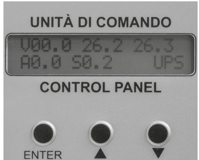
Mediante i tasti ▲ e ▼ è possibile visualizzare altri dati di monitoraggio del sistema:
