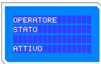
7. Premendo il tasto ENTER si può entrare nella sezione per la modifica dello stato (reset/attivo) → vedere il successivo paragrafo 6.2.1.
