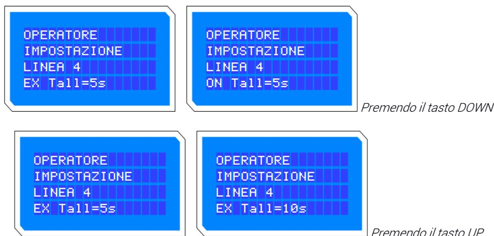
Premendo il tasto DOWN si abilita (ON) o disabilita (EX) il funzionamento della linea 4.
