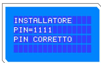
Premendo il tasto ENTER si entra nel menù di settaggio dei parametri.
