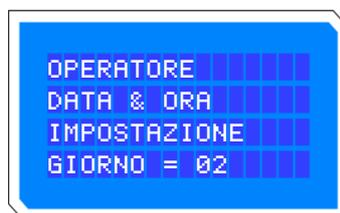
Premendo il tasto UP si incrementa e premendo il tasto DOWN si decrementa il valore dei giorni. Una volta impostato il valore desiderato, premere il tasto ENTER per passare al giorno della settimana.
