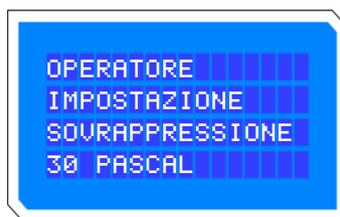
Premendo il tasto UP si aumenta la sovrappressione e premendo il tasto DOWN si diminuisce. Il range di impostazione è compreso tra 15 e 60 Pa. Una volta impostato il valore desiderato, premere il tasto ENTER per uscire dal menù.
