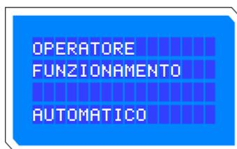
Premendo il tasto ENTER si accede alla schermata di modifica della modalità di funzionamento:
