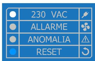
Quando l'unità Multimaster è in stato di RESET il display riporta la seguente dicitura:
