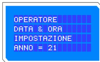
Premendo il tasto UP si incrementa e premendo il tasto DOWN si decrementa il valore degli anni. Una volta impostato il valore desiderato, premere il tasto ENTER per passare al mese.
