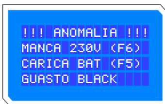
Guasto F6: manca alimentazione 230 V sull'unità Multimaster, oppure integrità danneggiata del fusibile F6 della scheda elettronica di alimentazione E003.0024 unità Multimaster, oppure integrità danneggiata del fusibile F9 sul morsetto di alimentazione 230 V unità Multimaster.
