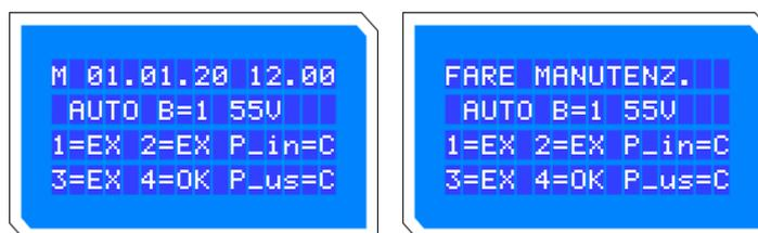
NB: questo messaggio è semplicemente un promemoria per il manutentore e non influisce in alcun modo sul funzionamento del sistema anche in caso di allarme. Se viene impostato lo stato di "RESET" il messaggio della manutenzione della prima riga scompare.
