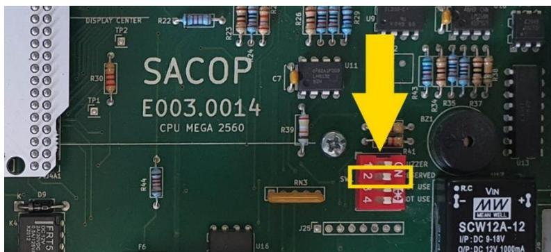
Figura 39 - Dip switch 2 su scheda elettronica CPU E003.0014 (unità Multimaster) per reset PIN installatore
