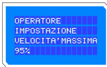
Premendo il tasto UP si aumenta la velocità e premendo il tasto DOWN si diminuisce. Una volta impostato il valore desiderato, premere il tasto ENTER per uscire dal menù.
