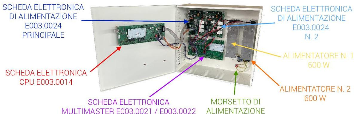
Figura 2 - Componenti principali unità Multimaster 4
