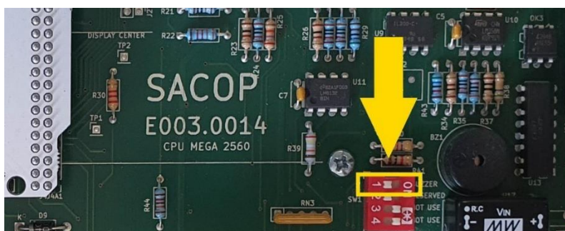
Figura 21 - Dip switch 1 su scheda elettronica CPU E003.0014 per silenziare il BUZZER
