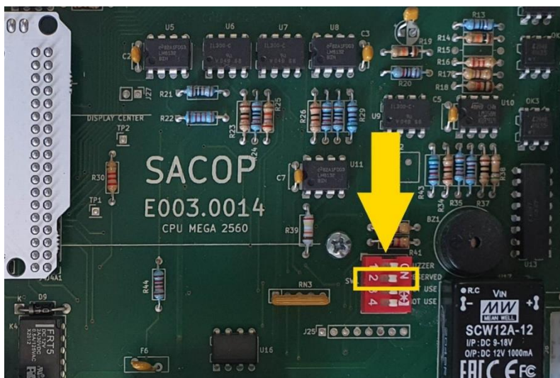
Figura 29 - Dip switch 2 su scheda elettronica CPU E003.0014 per reset PIN installatore
