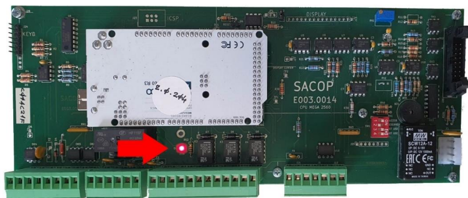
Figura 10 - Led ROSSO denominato DL5 RUN su scheda elettronica di alimentazione E003.0014
