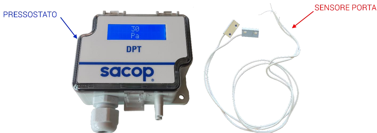
Figura 15 - Kit pressostato differenziale e sensori porta per la gestione automatica della velocità del ventilatore tramite la misura della sovrappressione del locale "filtro a prova di fumo" e della gestione delle fasi di apertura/chiusura delle porte di ingresso e uscita
