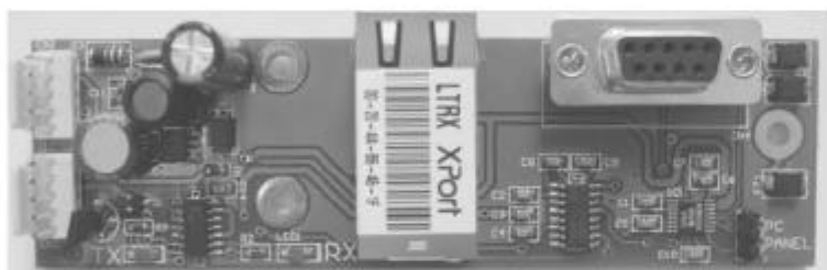
SCHEDA INTERFACCIA PER TCP/IP
