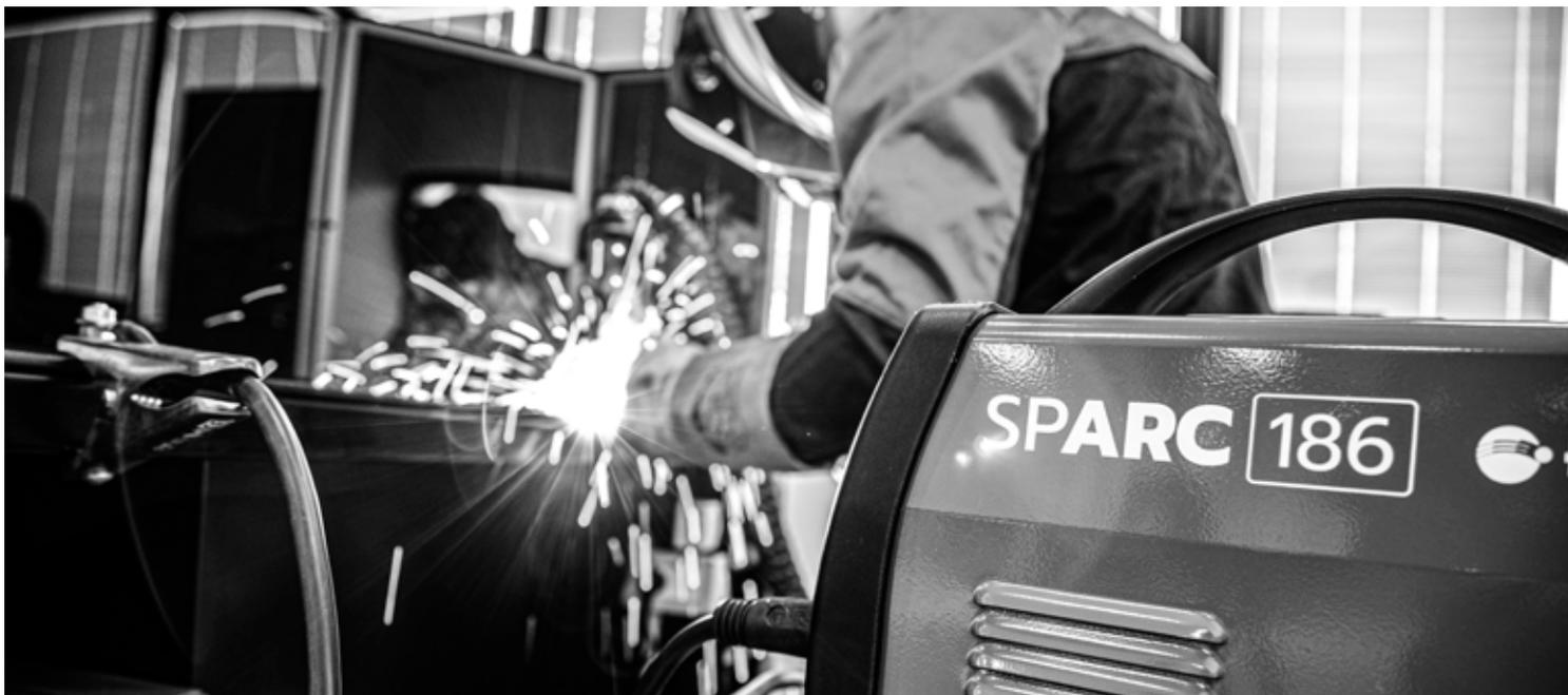
Inverter di saldatura facile da utilizzare, ottime caratteristiche di saldatura con tutti i tipi d'elettrodi commerciali (rutili, basici, inox). Dotati di controllo di sovratensione, sovratemperatura e antincollaggio dell'elettrodo. Sono compatti e leggeri, ideali per lavori di manutenzione domestica e semiprofessionale.
