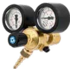
L'attacco posteriore, l'ingombro ridotto e la manopola di regolazione frontale rendono questi riduttori molto utilizzati nei kit di saldatura ossiacetilenica e ossipropanica. Sono forniti con cuffie di protezione dei manometri di colore nero e il gas di utilizzo è identificato dal bollino sulla manopola.
