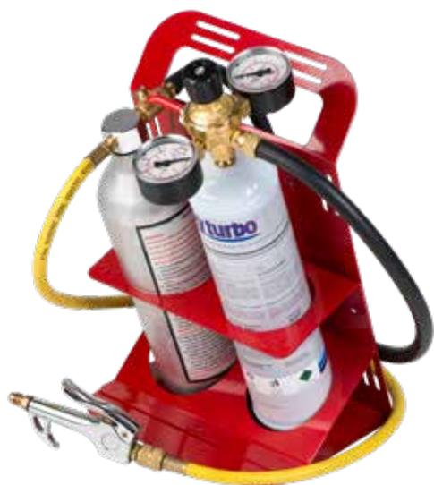
Un kit compatto e funzionale per il lavaggio interno delle tubazioni in rame e degli evaporatori negli impianti di condizionamento civili, industriali e di autoveicoli. Con una pressione di 10 bar riesce a rimuovere completamente le impurità che si depositano all'interno dell'impianto. Il comodo cestello ed il suo peso ridotto lo rendono adatto per l'impiego anche in situazioni scomode.
