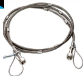
Serpentine flessibili in PTFE rivestito in treccia tessile, treccia inox e rivestimento protettivo nero termoplastico microforato con cavo di sicurezza antibrandeggio e maniglia di manovra per facilitare il collegamento alla bombola.
