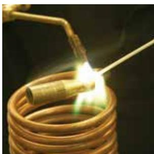
Si definisce metallo d'apporto il metallo che può essere utilizzato in aggiunta al metallo base per la saldatura. La giusta scelta del metallo d'apporto permette di effettuare una buona saldatura. Saper saldare significa scegliere una buona tecnica e un metallo d'apporto adatto al lavoro da effettuare. Per un aiuto può essere consultata la tabella che segue.
