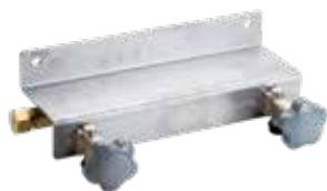
Sono l'ideale per fissare a parete in modo stabile un riduttore forte erogazione ed avere due ingressi separati per ottenere un sistema di riserva gas collegando ad esempio un pacco bombole all'ingresso 1 e una bombola all'ingresso 2 da attivare durante il cambio pacco per non avere nessuna interruzione dei processi lavorativi. È possibile anche collegare la rampa ad un quadro di decompressione tramite una serpentina flessibile.
