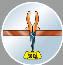
Test di aderenza dei manici dell'utensile
