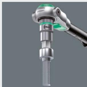
Le viti ad esagono cavo s'incastano sull'inserto-bussola grazie ad una sfera a molla sull'inserto. Specialmente utile negli spazi difficilmente raggiungibili nei quali non si può usare la seconda mano per trattenerne la vite.
