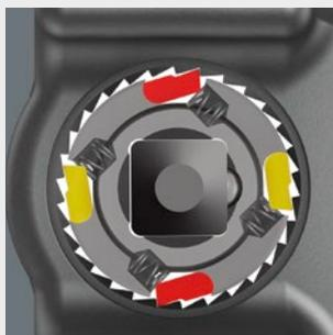
Ingranaggio con doppio nottolino. Conferisce ai 30 denti l'effetto di una dentatura fine a 60 denti con angolo di richiamo di soli 6°.
