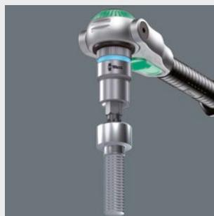
Gli utensili TORX® HF progettati dalla Wera si distinguono per la geometria ottimizzata del profilo TORX® originale. Grazie alla forza d'incastro derivante dalla pressione superficiale tra la punta dell'inserto e l'impronta della vite, le viti TORX®, secondo le superfici della Acument Intellectual Properties, vengono tratteneute sull'utensile! Specialmente utile negli spazi difficilmente raggiungibili nei quali non si può usare la seconda mano per trattenerne la vite.
