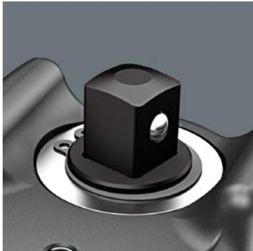
L'attacco quadro passante aziona la reversibilità e garantisce una elevata resistenza, dato che non viene impiegato un delicato meccanismo di inversione che potrebbe guastarsi con le martellate.
