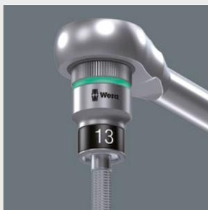
Il bloccaggio nella chiave della vite con testa esagonale, avviene tramite due sfere ed una guaina elastica ad alta resistenza. Quest'ultima viene protetta efficacemente da un collare d'acciaio contro lesioni meccaniche. Particolarmente d'aiuto in spazi di lavoro difficilmente raggiungibili, laddove non si può usare la seconda mano per trattenerne la vite.
