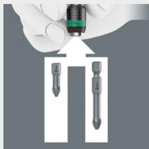
Il dispositivo a cambio rapido Rapidaptor è adatto per inserti con attacco da 1/4" sia secondo DIN ISO 1173-C 6,3 (inserti Wera della serie 1) che con E 6,3 (inserti Wera della serie 4).
