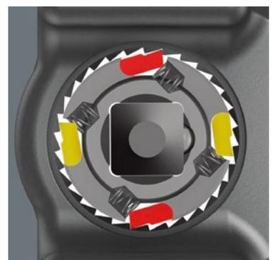
Ingranaggio con doppio nottolino. Conferisce ai 30 robusti denti l'effetto di una dentatura fine a 60 denti, con angolo di richiamo di soli 6°.
