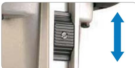
*Cambio di velocità meccanico. Il selezionatore deve essere spostato a motore spento.*
